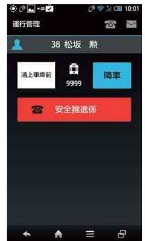
運行管理システムは、全乗務員が専用スマートフォン端末を携帯し、端末のGPS測位、端末アプリでの車号入力と系統設定により運行中の車両の運行状況を各営業所のディスプレイで把握できるシステムとなっている。運行状況が詳細に把握できるようになり、より効率的な配車をするための判断材料として活用されている。
